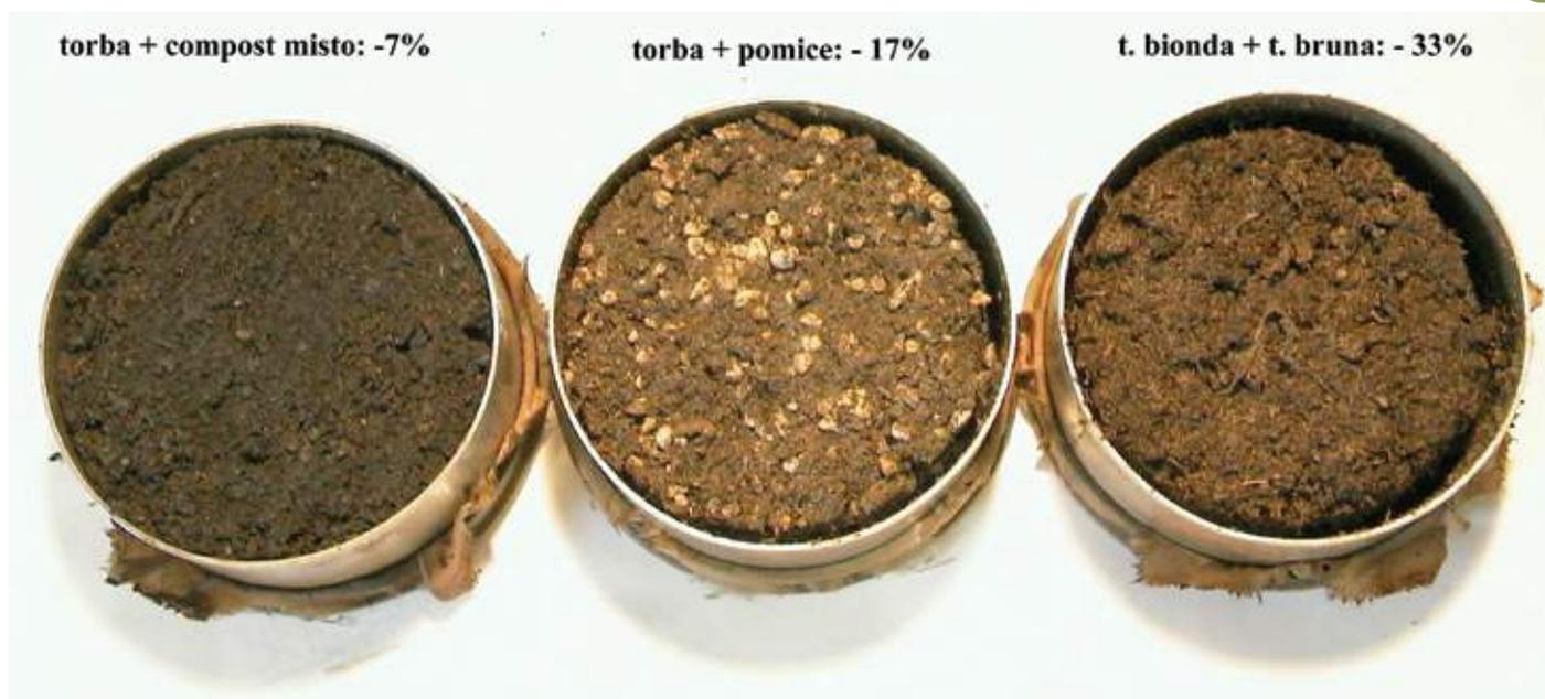
Differente grado di restringimento in tre substrati di coltivazione con conseguente perdita di volume (%)
